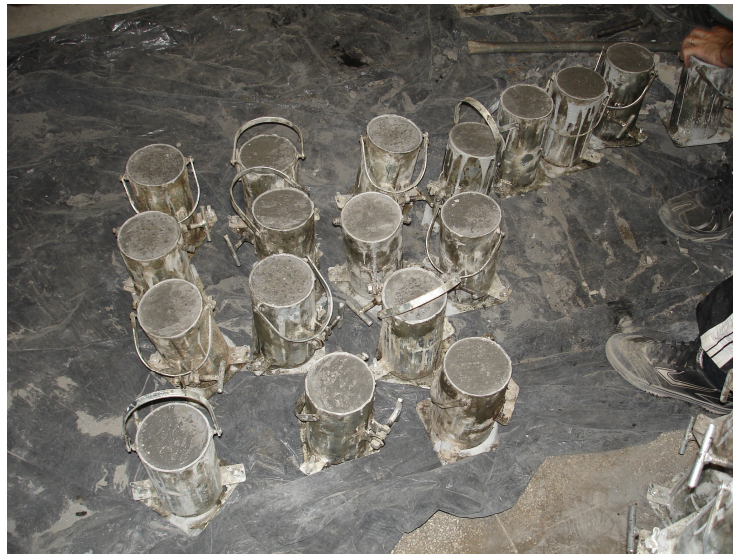
Figura 34 Desmoldagem após as primeiras 24 horas após a mistura
