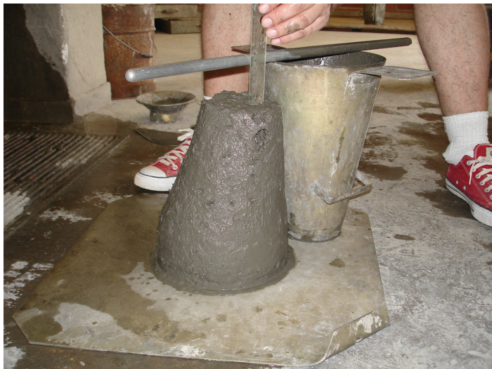
Figura 32 – Abatimento do concreto
