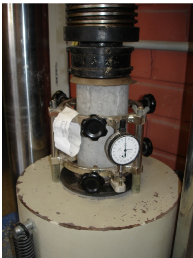
Figura 39 – Ensaio de módulo de elasticidade
