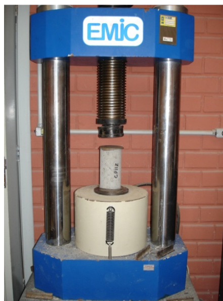
Figura 36 – Ensaio de compressão axial
