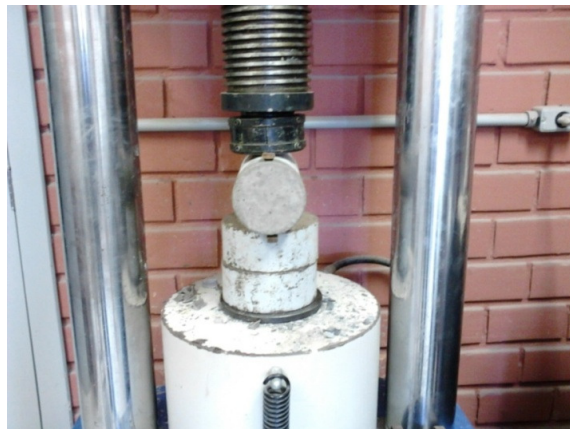
Figura 37 – Ensaio de compressão diametral
