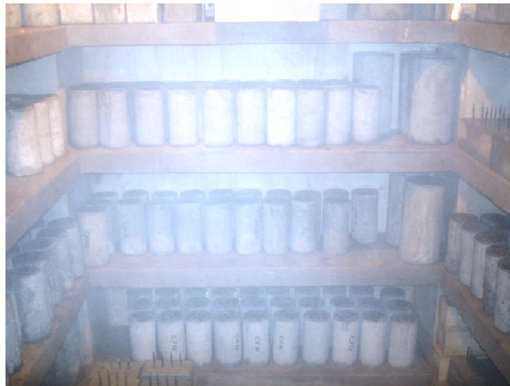
Figura 35 – Corpos de prova curando na câmara úmida
