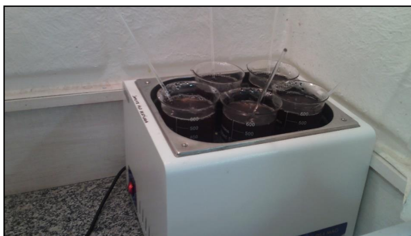
Figura 10 - Processo de fervura das amostras no processo de hidrólise ácida da madeira para retirada dos polissacarídeos totais
