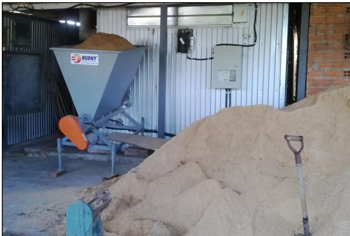
Figura 5 - Unidade de cura de ar forçado alimentada por serragem.
