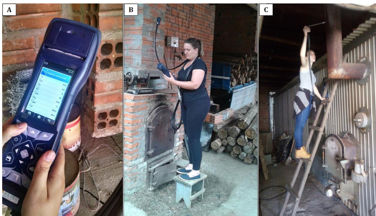
Figura 18 - A : Analisador de gases de combustão Chemist 500x. B e C : Medição dos gases através da inserção da sonda em orifício aberto na saída das chaminés
