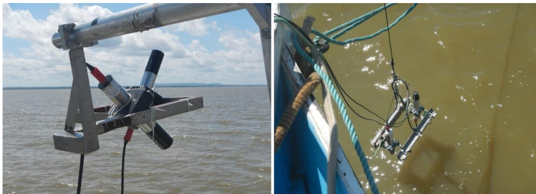
Figura 14 - Sensores TriOs acima da água e em subsuperfície
