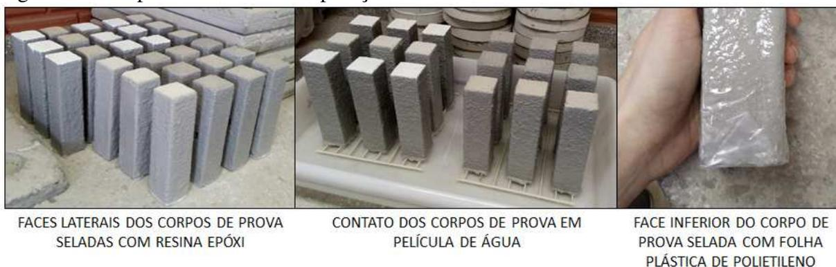
Para os revestimentos de recuperação superficial, foram utilizados corpos de prova da argamassa referência industrializada (AP-IND-RM), os quais receberam, nas quatro faces laterais, selagem pela resina epóxi e, na face superior, foram revestidos por tais revestimentos.
