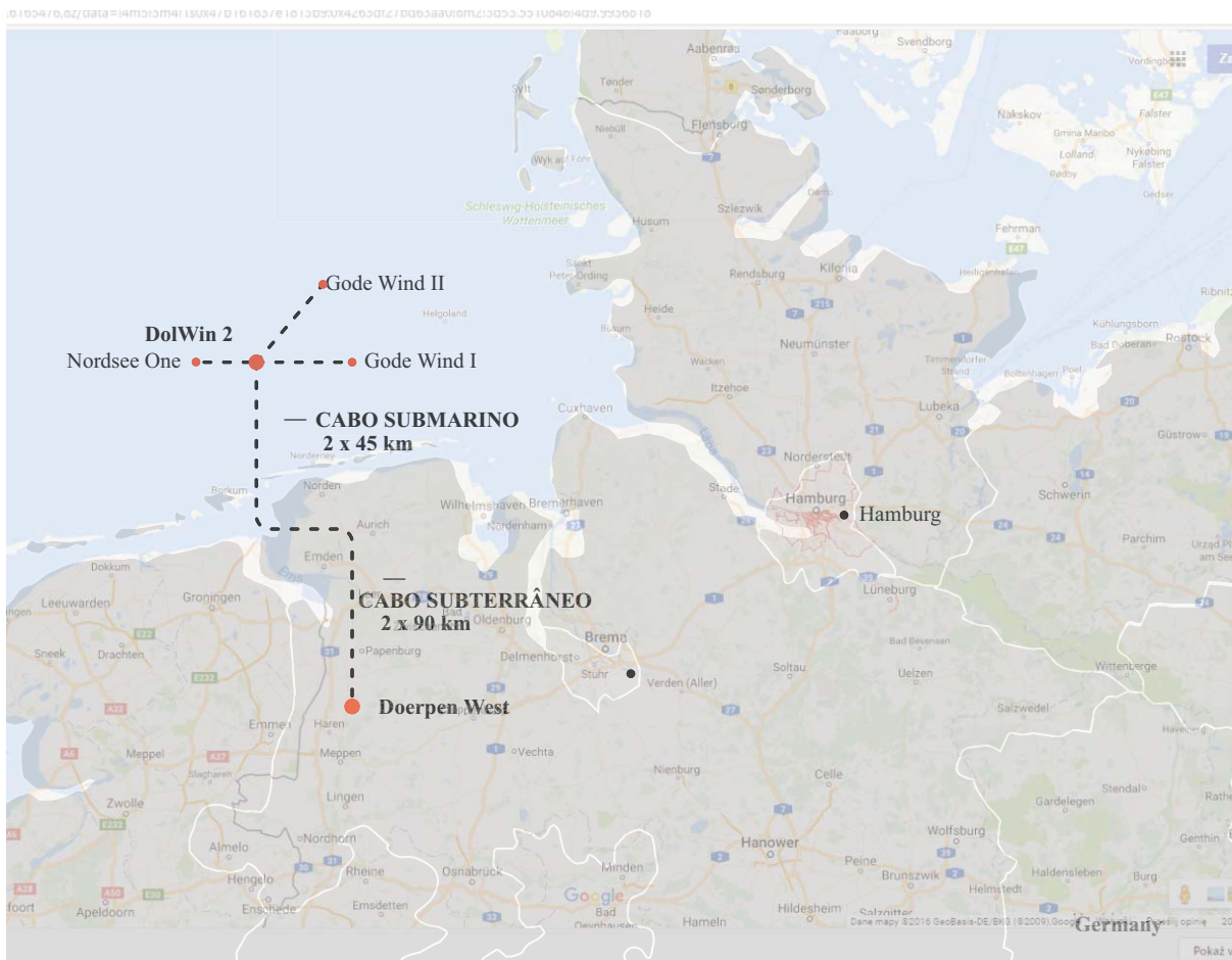
Figura 1.19 – Projeto Dolwin 2 instalado em 2016, com capacidade de transformação de 916 MW, coleta energia de três parques eólicos diferentes.
