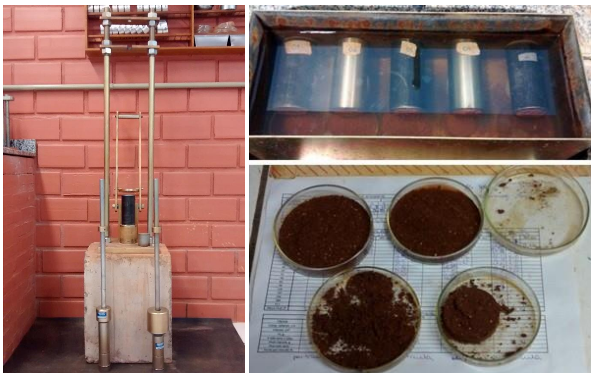
Figura 3.9 – Ensaio para classificação MCT
