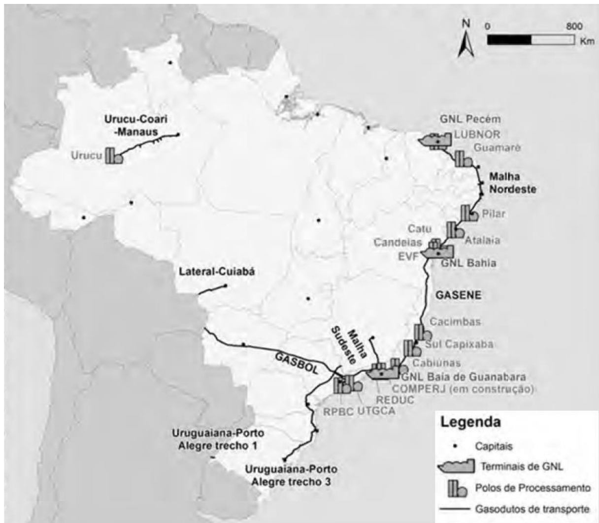
Figura 10 – Infraestrutura de processamento e transporte de gás natural existente e em construção no Brasil.
