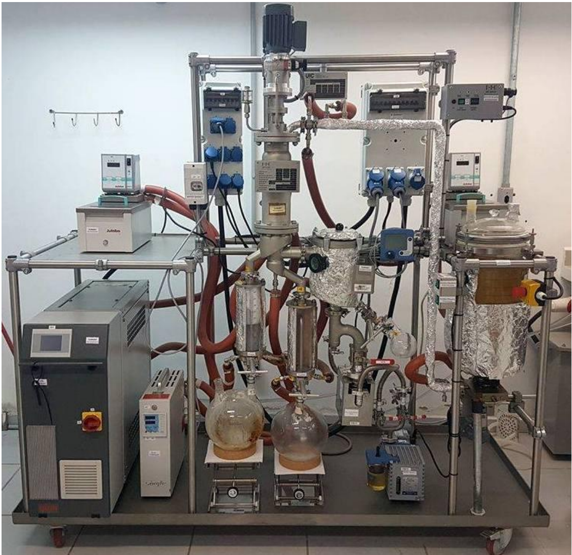
Figura 4 - Destilador molecular de filme descendente modelo KD6 (UIC GmbH – Alemanha).
