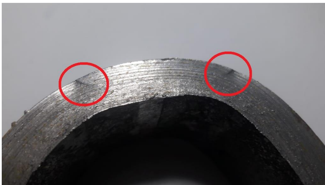
Figura 23 - Material com comportamento frágil, apresentando trincas na ZAC.
