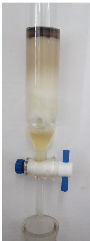
Após realizar todas as etapas conforme a metodologia de referência baseada no método descrito por Payzant, as três classes compostos são coletadas em frascos e dissolvidas com 40 mL de tolueno. Com estas três frações preparadas, a quantidade de enxofre total é determinada por meio da espectroscopia de fluorescências de raios X. A imagem abaixo, ilustra as três frações finais obtidas a partir do método A:
