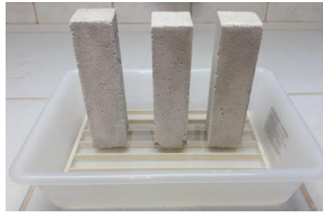
Corpos de prova imersos
