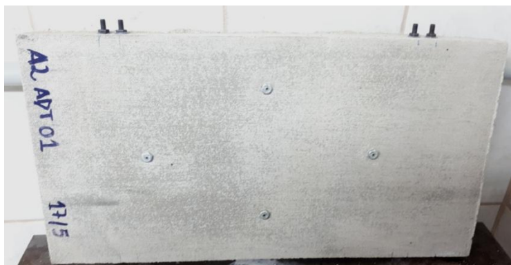
Colocação dos pinos laterais
