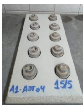
Colagem das pastilhas metálicas
