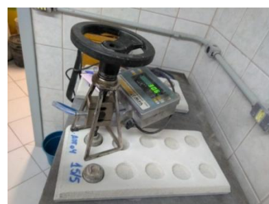
Aplicação da carga de tração
