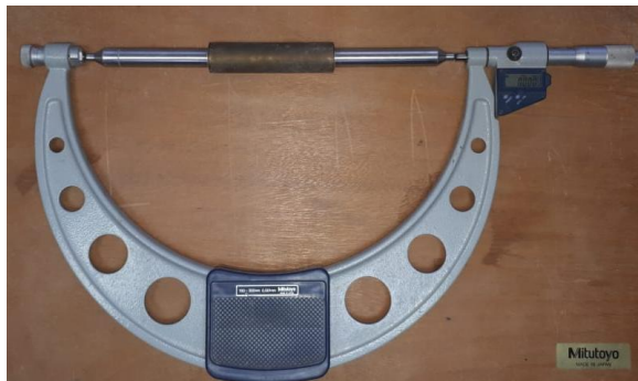
Processo de calibração (zero)
