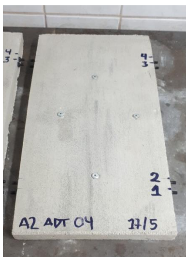
Placa após a colocação dos pinos
