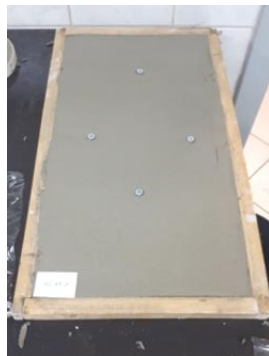
Moldes com argamassa
