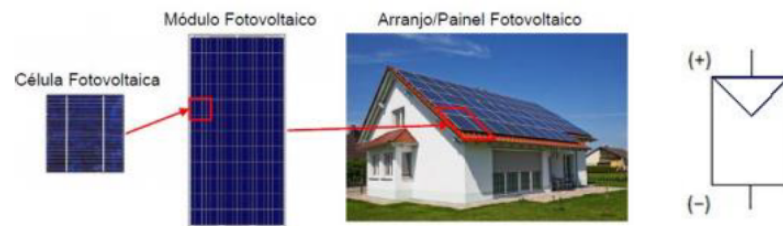
Figura 2.6 – Demonstração dos Diferentes Conceitos e símbolo elétrico de módulo fotovoltaico. Fonte: Buiatti(2014).
