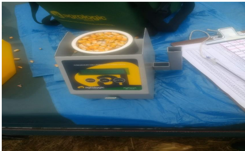
Figura 16 – Equipamento utilizado para medir a umidade dos grãos.
