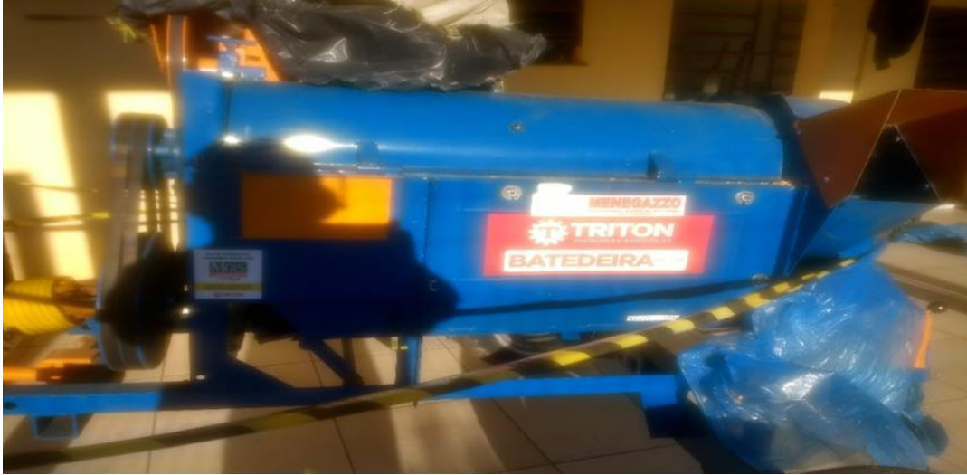
Figura 18 – Debulhadora utilizada para a separação do grão de milho da espiga.
