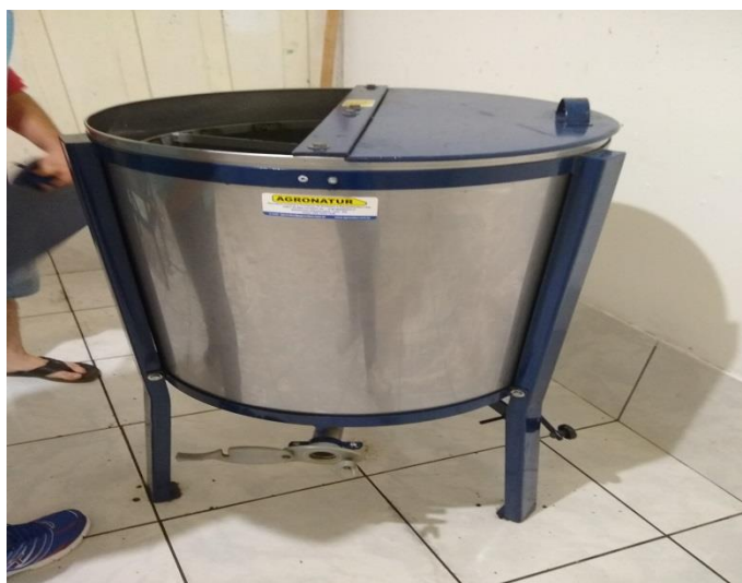
Figura 7 Centrífuga elétrica de mel
