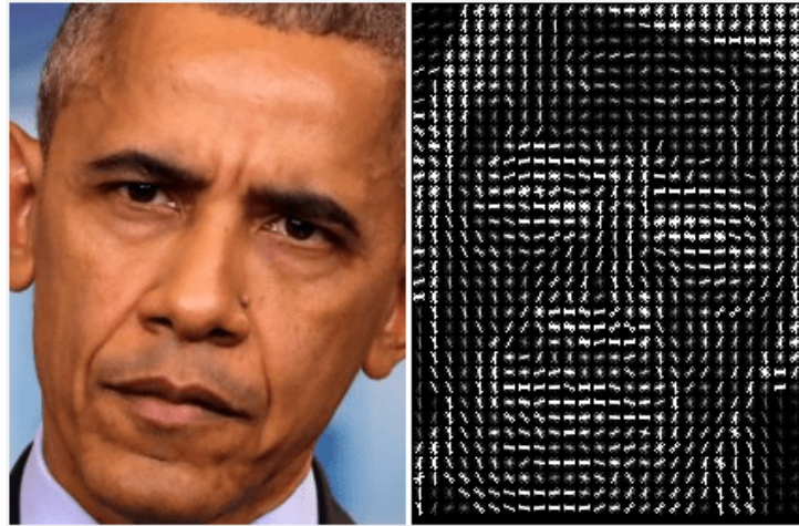
Figura 2.1 – Imagem com a face normal e a direita seu vetor HOG que será usado no classificador.
