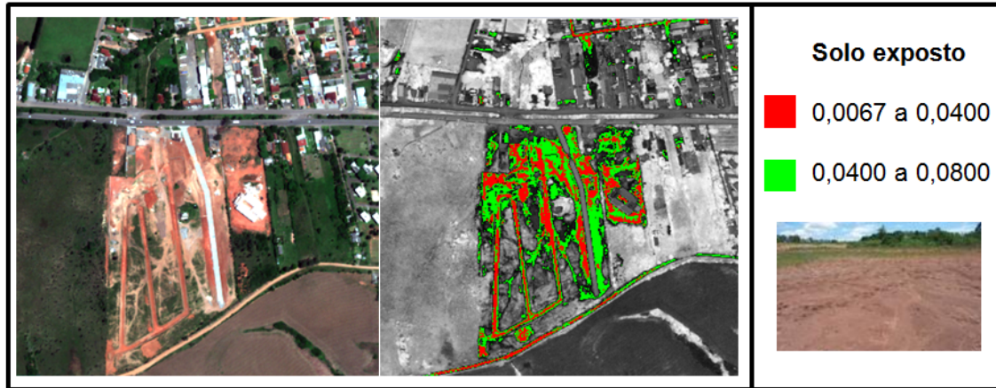
Figura 4.39. Composição colorida GeoEye-1 (R3-G2-B1) a esquerda e imagem SAM (ângulo) à direita, com os valores angulares correspondentes para as áreas de solo exposto. A imagem mostra a clara discriminação das áreas de solo exposto e confusão com estrada de terra.
