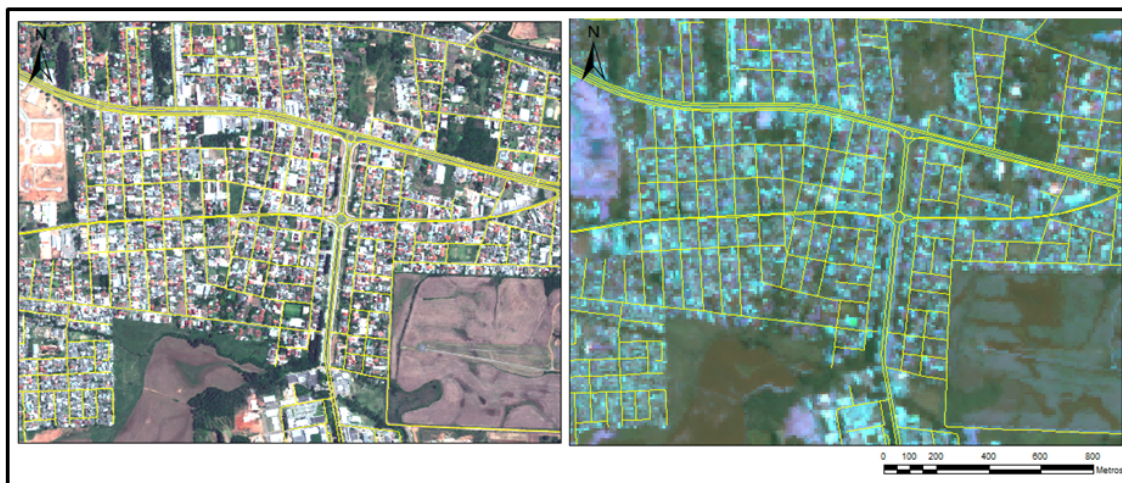
Figura 4.3. Correspondência espacial entre a imagem GeoEye-1 (esquerda) e imagem SPOT 5 (direita) com a base digital de ruas municipais. Fonte: Elaboração própria.
