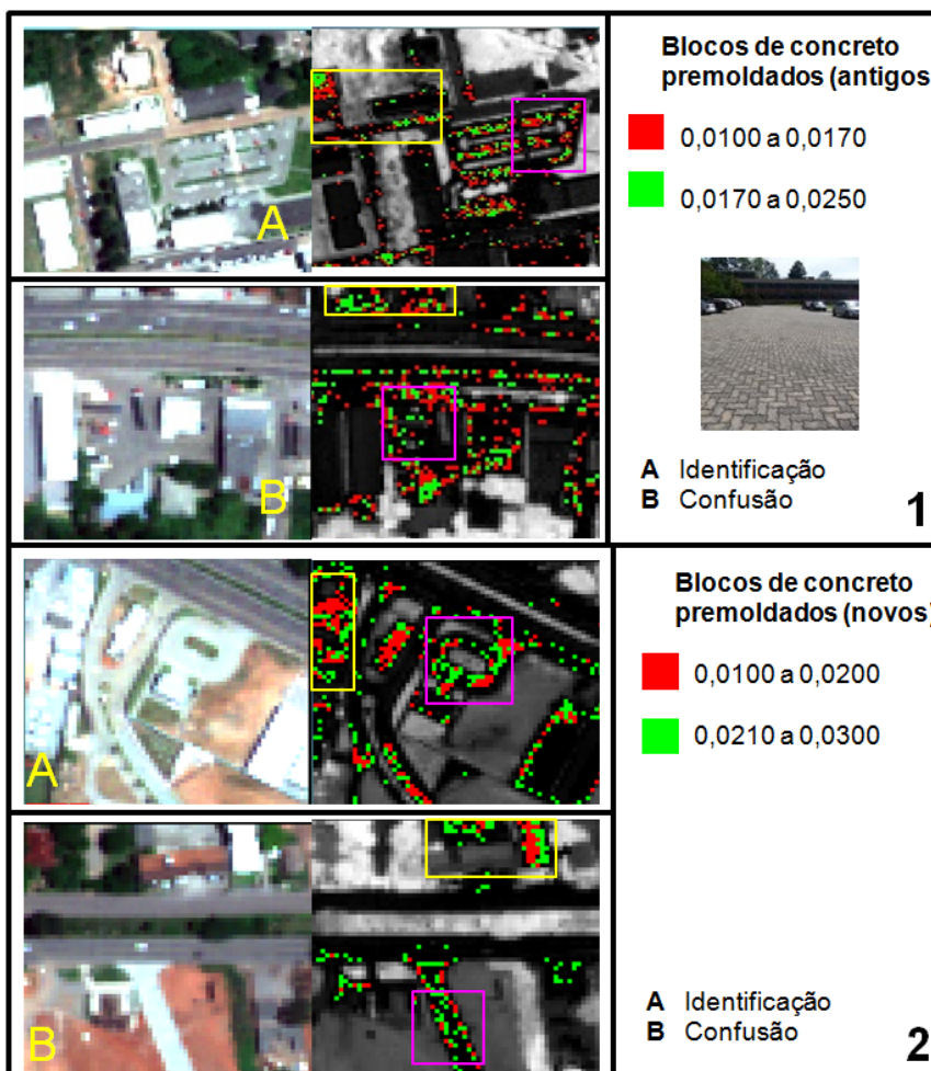
Figura 4.43 Composição colorida GeoEye-1 (R3-G2-B1) a esquerda e imagem SAM (ângulo) à direita, com os valores angulares correspondentes para blocos de concreto pré-moldados antigos e novos.
