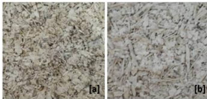
Figura 16 – Amostra sem [a] e com a adição de Benzoato de Sódio [b]
