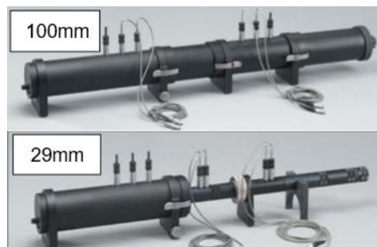
Figura 6 – Tubos de impedância de 100 mm e 29 mm de diâmetro interno
