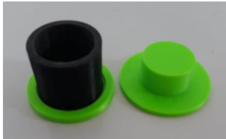
Figura 17 – Molde para corpos de prova do ensaio em tubo de impedância
