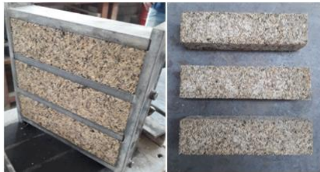
Figura 28 – Corpos de prova para ensaio de flexão em três pontos
