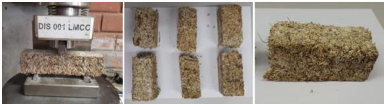
Figura 29 - Ensaio de flexão e seção transversal das três amostras após fratura
