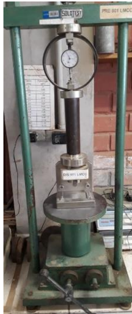
Figura 21 – Equipamento usado no ensaio de flexão em três pontos
