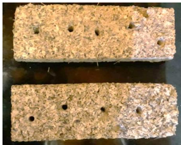
Figura 30 – Compósito após perfuração no ensaio de funcionalidade
