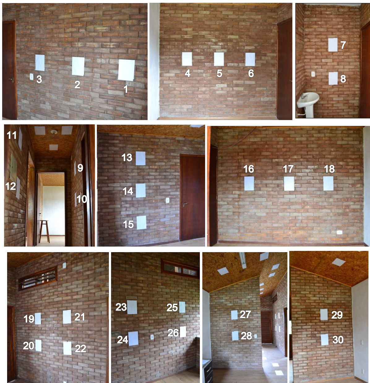
Figura 30 - Pontos de medições de iluminância refletida nos tijolos a vista.
