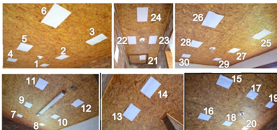
Figura 41 - Pontos de medições de iluminâncias refletidas do forro de painéis OSB.
