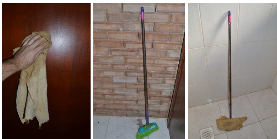
Figura 28 - Limpeza das superfícies de medições de iluminância refletida.
