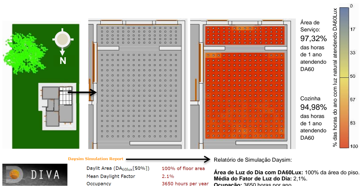
Figura 52 - Simulação para avaliação do ambiente cozinha/ área de serviço pelos parâmetros do RTQ-R.
