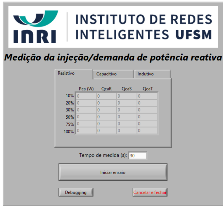
Figura 4.21 – Painel Frontal: Injeção/Demanda de potência reativa
