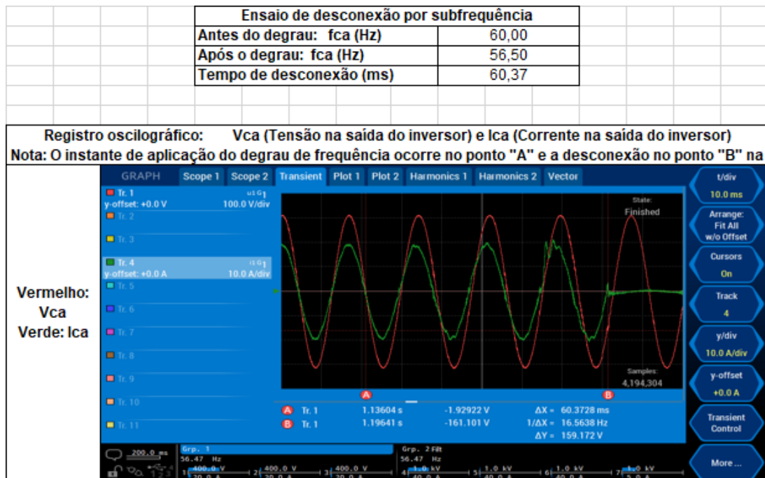
Figura 5.16 – Resultado manual: Tempo de desconexão por sobrefrequência
