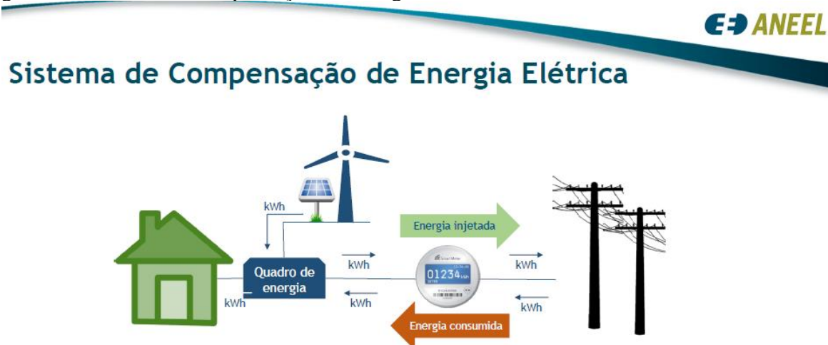
Figura 8 – Sistema de Compensação de Energia Elétrica
