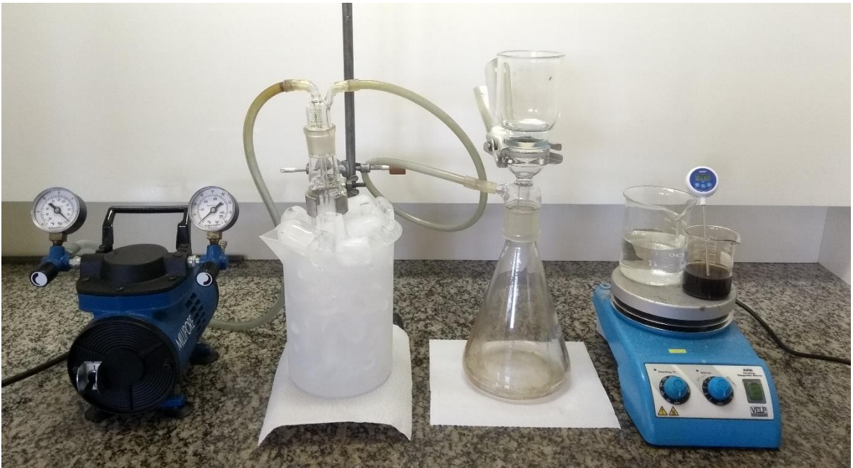
Figura 6 - Sistema utilizado para determinação do teor de sedimentos nas amostras de petróleo.
