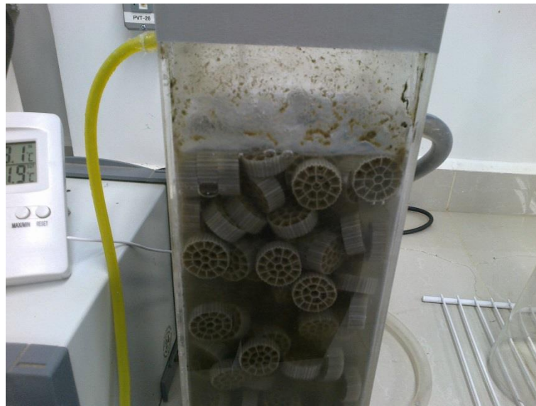
Figura 13 – Reator MBBR na fase de aclimação.
