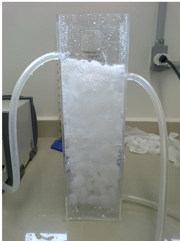
Figura 12 – Testes iniciais do MBBR.
