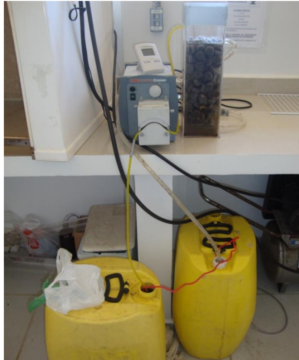
Figura 11 – Foto do sistema de tratamento utilizando o reator MBBR.
