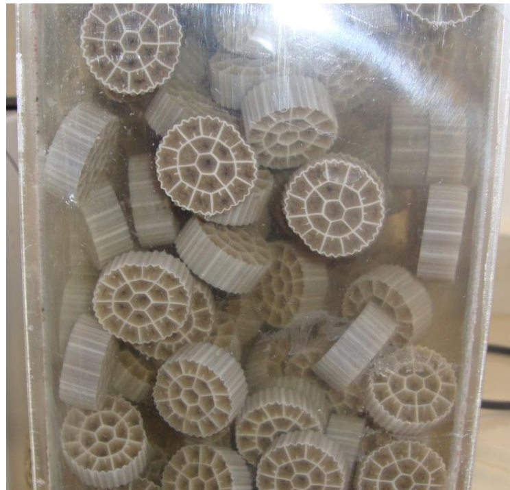
Figura 16 – Suportes em suspensão no interior do reator MBBR.
