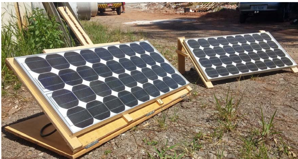
Figura A.1: Estruturas construídas para ensaio de painéis fotovoltaicos em diferentes posicionamentos.
