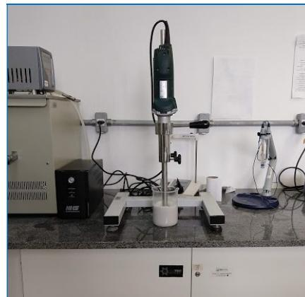
Figura 4 - Agitador mecânico turrax.
