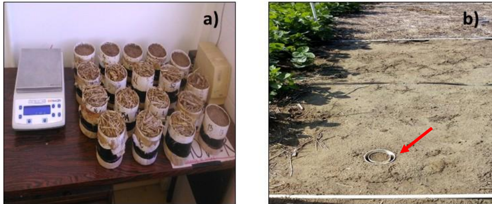
Figura 6 - Microlisímetros construídos para determinação da evaporação da água do solo.
