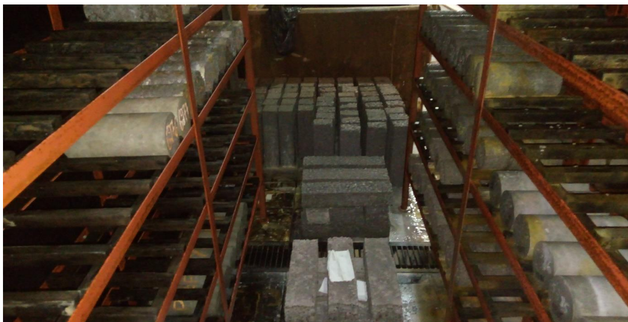
Figura 27 – Cura de CPs do ensaio de RTF
