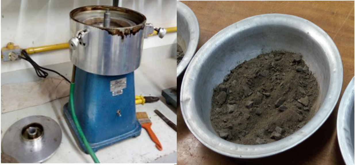
Figura 12 – Imagem de agregados após o ensaio de Rotarex
