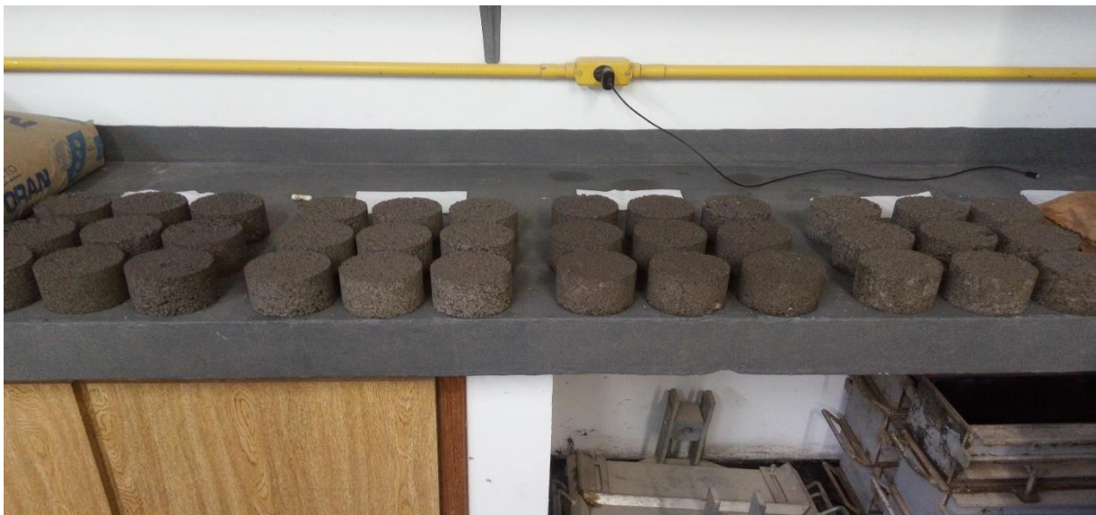
Figura 23 – Desmoldagem de CPs para RTCD e MR e conferencia de aceitação
