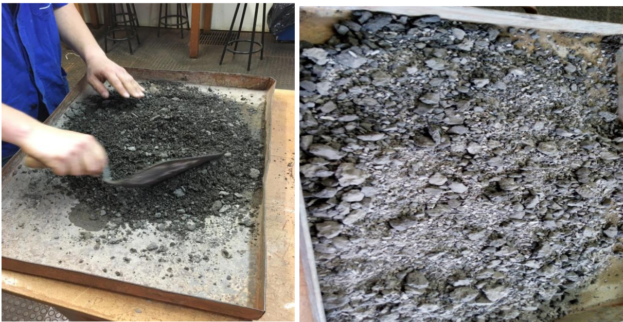
Figura 15 – Mistura de fresado e pó-de-pedra
