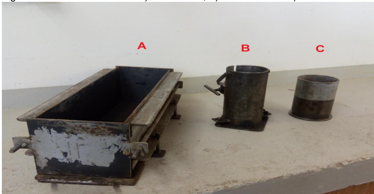
Figura 18 – Moldes utilizados: A) ensaio RTF; B) ensaio RCS e C) ensaio RTCD/MR
