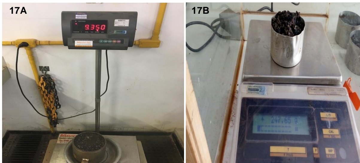
Figura 16 – (A) pesagem amostra úmida e (B) Pesagem de amostra seca (estufa);
