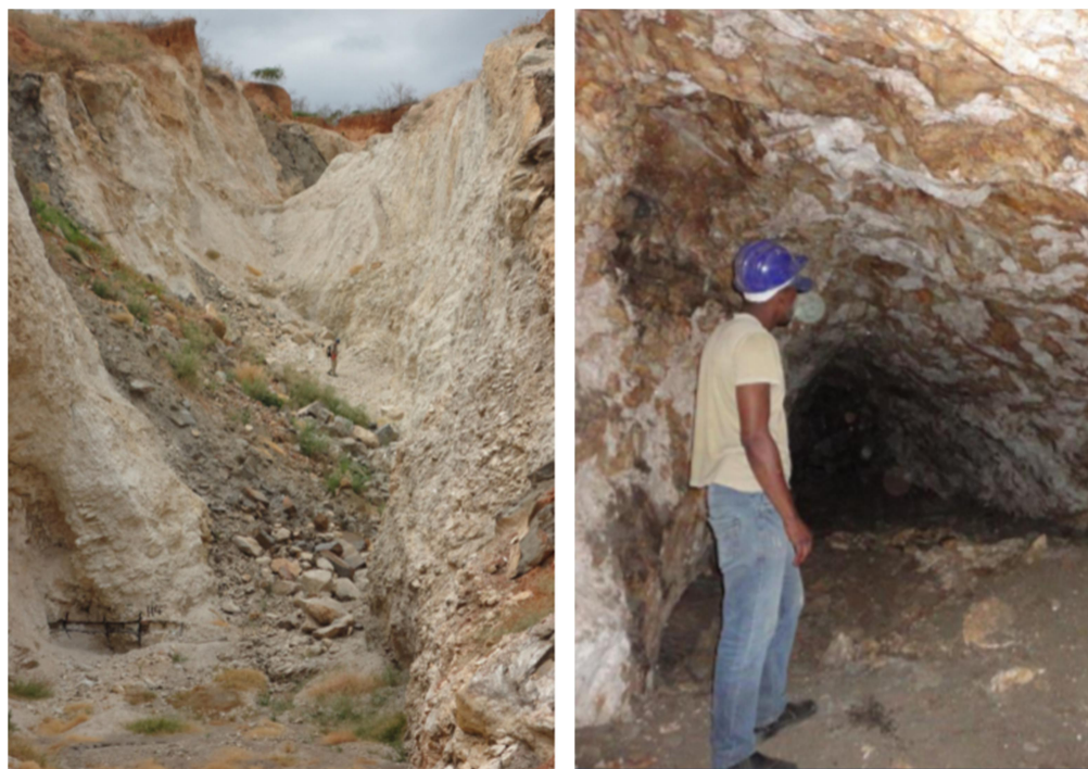
Figura 46 – Lavras do campo pegmatito de Itinga: a esquerda: cava para lavra a céu aberto (Lavra do Meio); a direita: túnel de uma lavra subterrânea (Mina da Tesoura).
