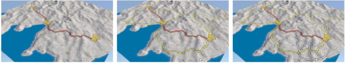
Figura 3.8 – Diferentes etapas do processo de geração de uma rede hierárquica de estradas utilizando o método proposto por Galin et al. (2011).
