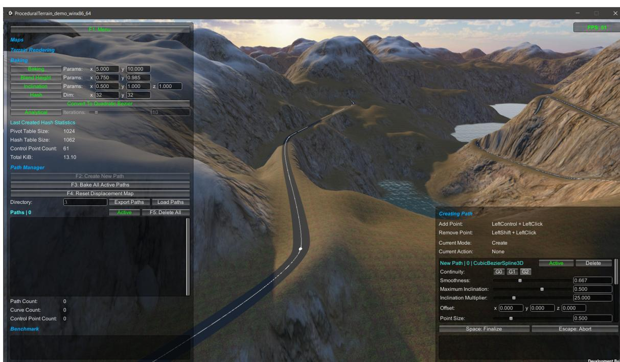
Figura 8.1 – Captura de tela do protótipo implementado para validar a técnica proposta. A aplicação permite ao usuário inserir e remover caminhos e modificar os parâmetros de terraplenagem.
