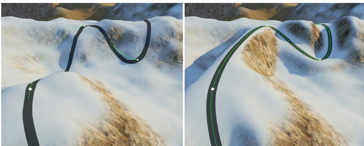
Figura 7.1 – Terreno sem deslocamento (esquerda) e deslocamento total (direita) ao longo de um caminho.
