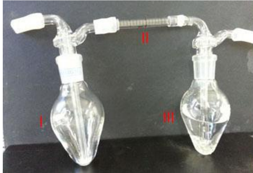
Figura 6 – Segundo sistema testado com traps em linha.
