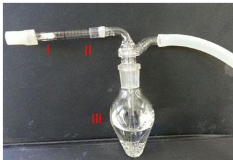
Figura 7 – Terceiro sistema testado com apenas um trap .
