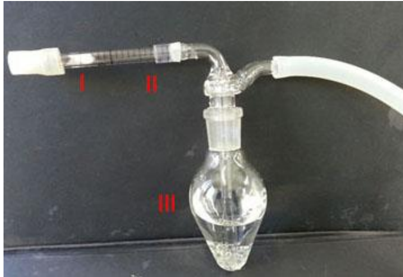
Figura 8 – Terceiro sistema testado com apenas um trap .
