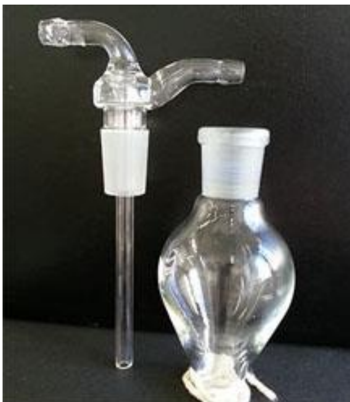
Figura 3 – Exemplo de trap utilizado nos experimentos e a tampa com linha de entrada e saída.
