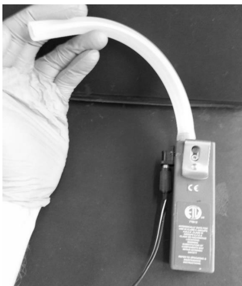
Figura 31 – Bomba de lapela utilizada para gerar o fluxo de ar no sistema.
