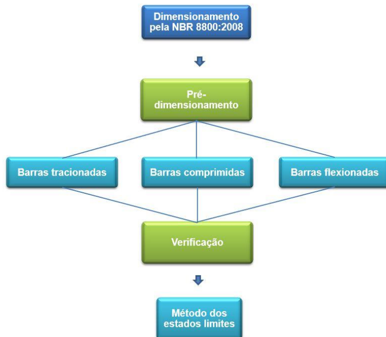
Figura 19 - Diagrama prático de dimensionamento segundo a NBR 8800:1986.
