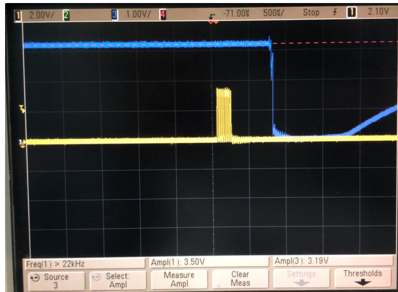
Figura 3.23 – Onda transmitida pelo microcontrolador (1) e sinal enviado para o microcontrolador após a recepção (3).
