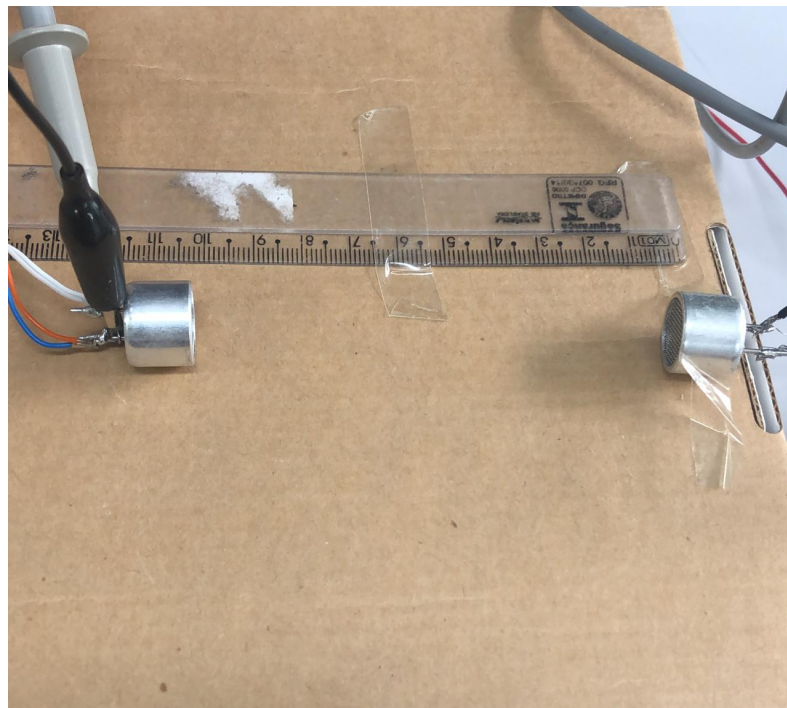
Figura 3.24 – Obtenção de dados no teste de medição de distância direta.
