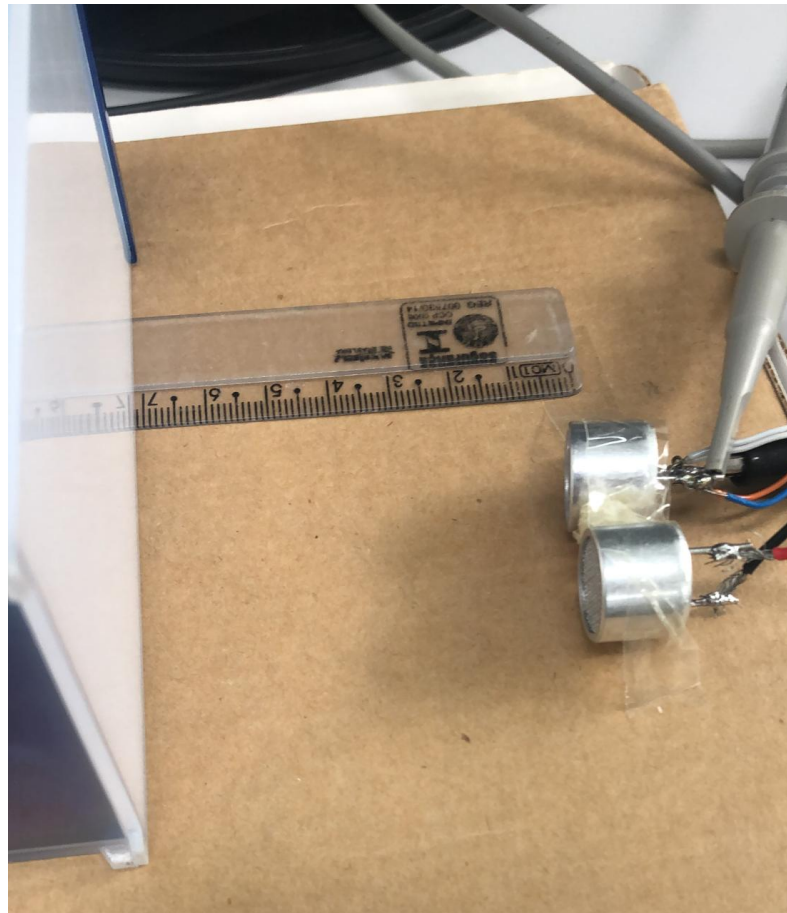
Figura 3.25 – Obtenção de dados no teste de medição de distância por reflexão.
