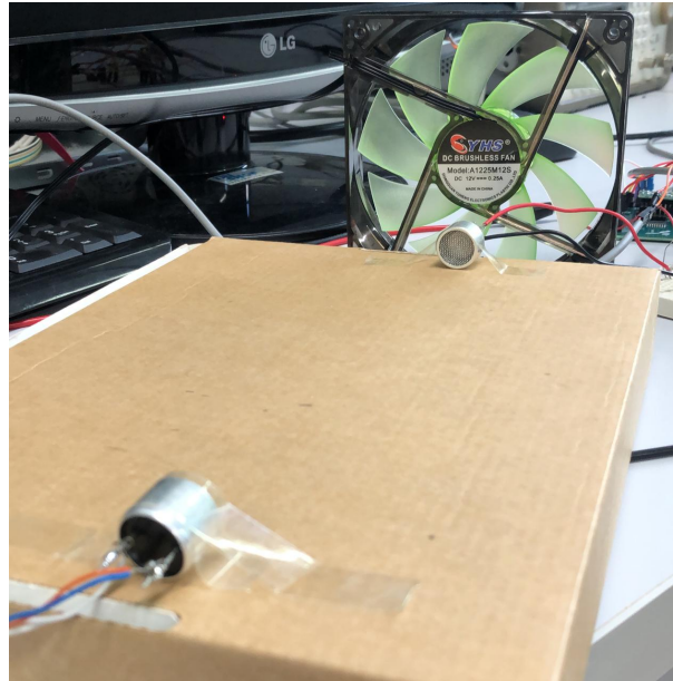
Figura 3.27 – Obtenção de dados para o teste de velocidade do ar com cooler.
