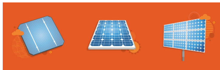
Figura 3.4 – Representação de uma célula, um módulo e um painel fotovoltaico.
