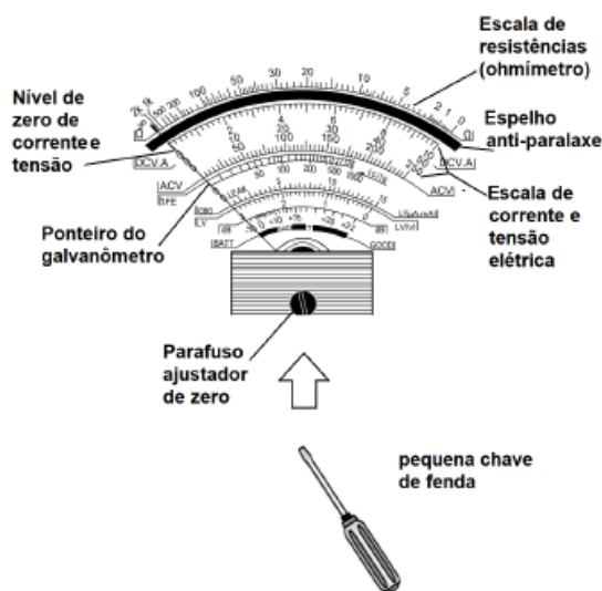
Figura 5: Identificação das escalas e o procedimento de ajuste de zero mecânico, quando o mesmo for colocado na situação de medida de tensão ou corrente.
