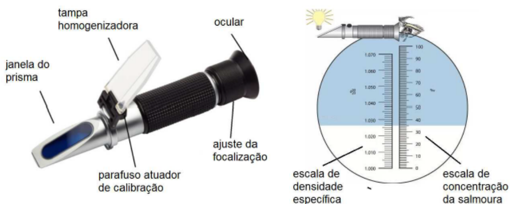
Figura 4: Esquema de um refratômetro comercial em escala de salmoura e a escala de sombra azulada visualizada através da sua ocular.
