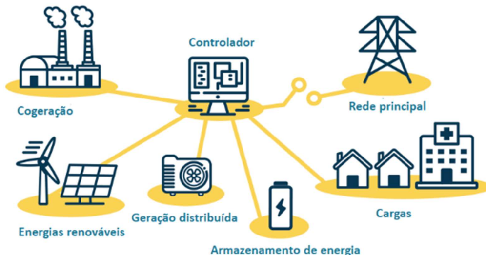
Figura 3 - Exemplo de microrrede e seus possíveis componentes
