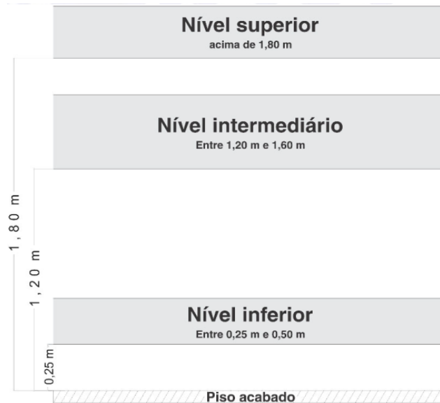
Figura 8 – Níveis de instalação das sinalizações de emergência
