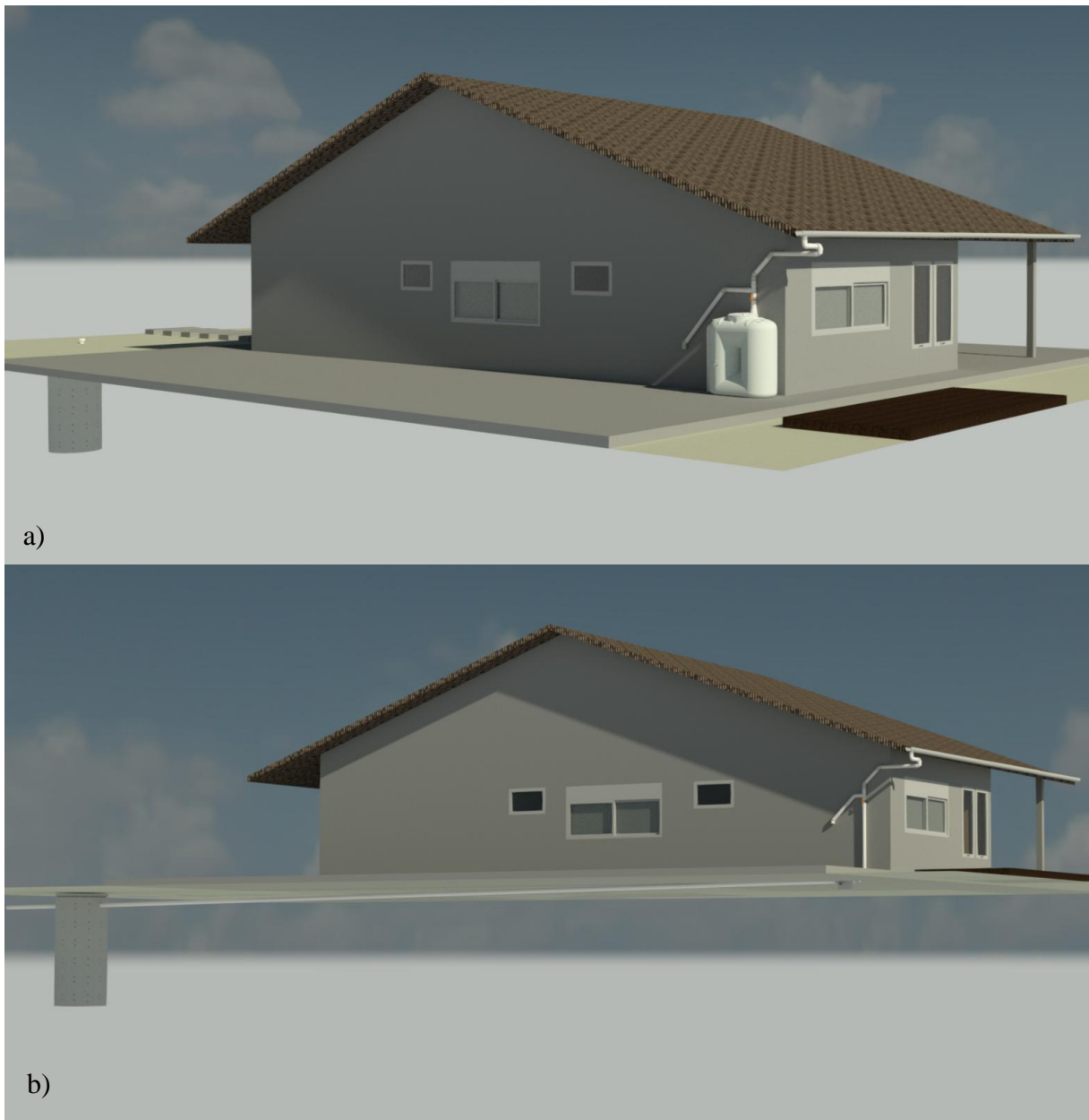
Figura 19 – Vistas gerais a) associação de reservatório de aproveitamento e poço de infiltração ao sistema de drenagem urbana b) associação de poço de infiltração à drenagem urbana
