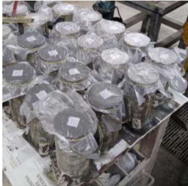
Figura 18 - Acondicionamento dos corpos de prova após moldagem
