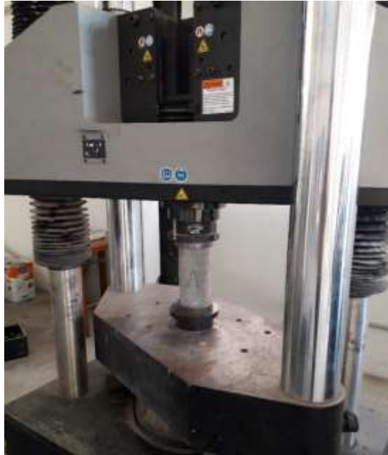
Figura 21 - Ensaio de resistência a compressão axial sendo realizado
