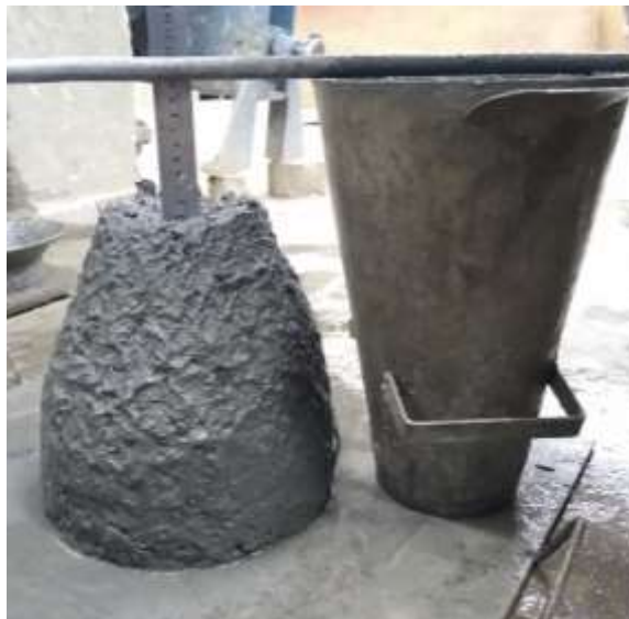
Figura 17 - Abatimento do tronco de cone
