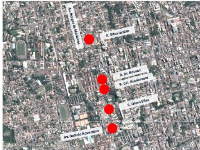
Figura 15 - Pontos de instalação de semáforos na Avenida Borges de Medeiros
