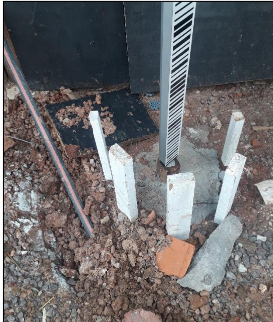
Figura 11 - Ponto de controle fixado na estaca (PC1).
