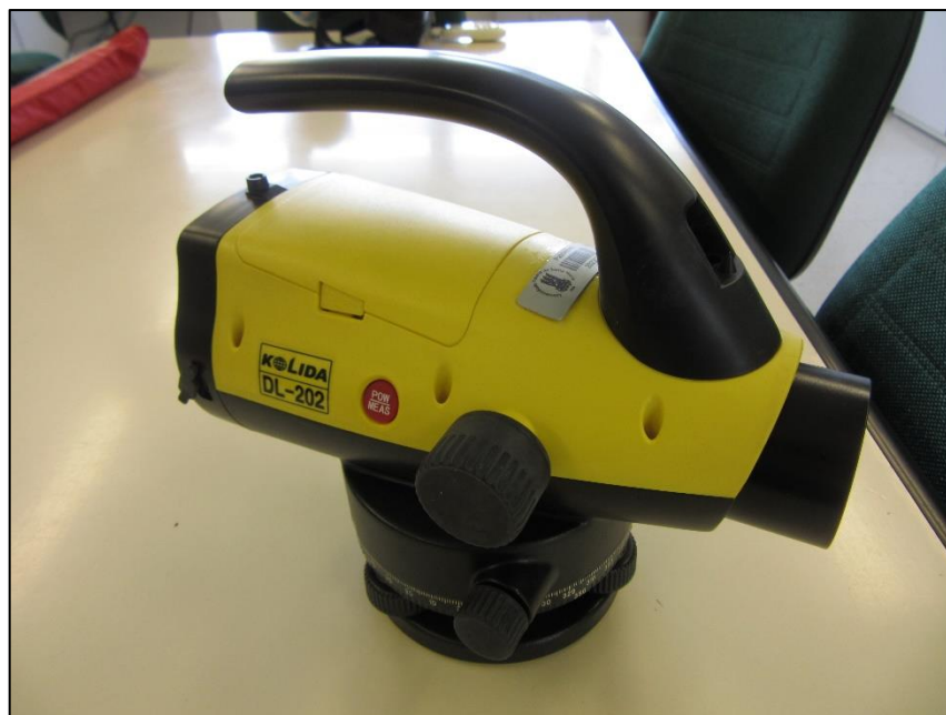
Figura 16 - Nível eletrônico digital Kolida DL - 202.
