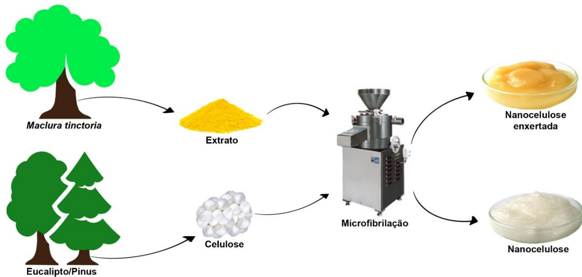
Figura 3 - Esquema de confecção e biofuncionalização do gel de nanocelulose.
