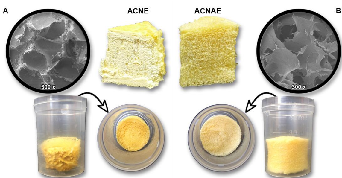
Figura 7 – Comportamento estrutural e morfológico dos aerogéis com adição de extrato de Maclura tinctoria .
