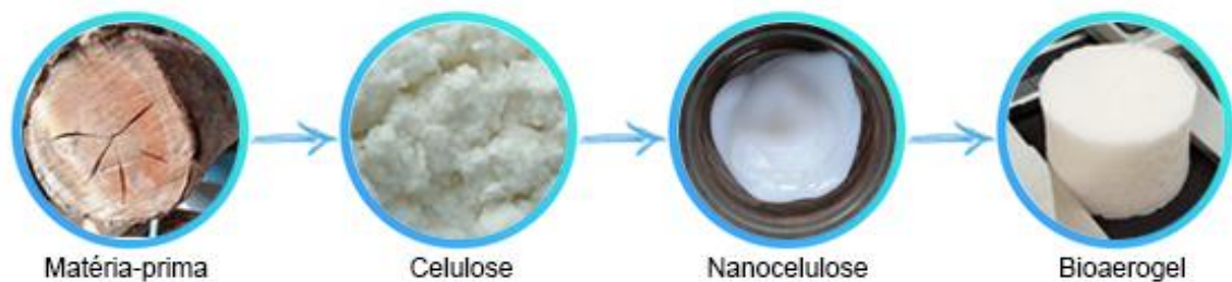
Figura 2- Esquema da transformação da matéria-prima em aerogéis.
