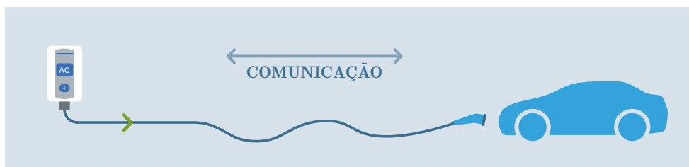
Figura 2.4 – Modo de carregamento 3 em CA.
