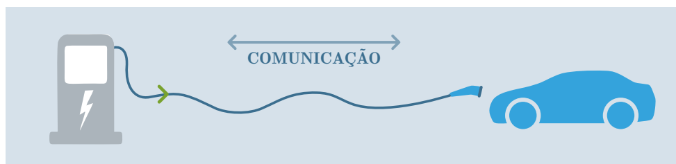
Figura 2.5 – Modo de carregamento 4 em CC.
