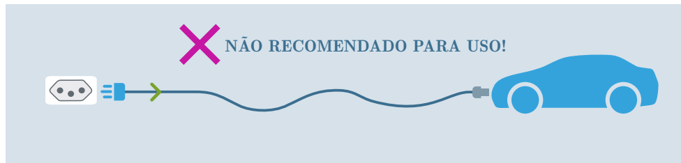
Figura 2.2 – Modo de carregamento 1 em CA.
