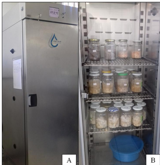
Figura 3 - Câmara climática (A) e fermentação em estado sólido em tubos de vidro (B).
