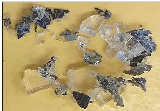
Figura 12. Material aderido aos componentes delaminados do módulo fotovoltaico.
