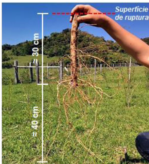
Figura 46 – Aspecto geral de parte do sistema radicial de uma planta de Phyllanthus sellowianus da classe de crescimento 5, com raízes ultrapassando 40 cm além do comprimento final da estaca. A linha vermelha pontilhada indica a posição da superfície de cisalhamento, abaixo da mesma a estaca está inserida mais 30 cm no solo
