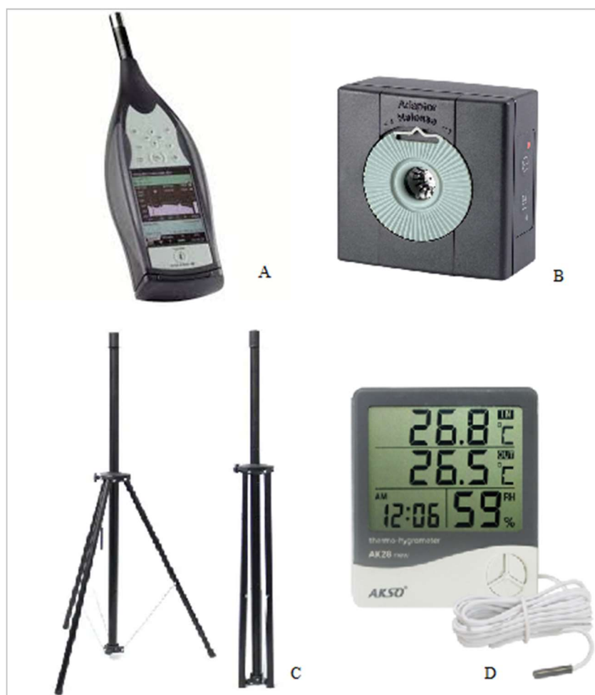
Figura 22 - Imagens ilustrativas dos equipamentos utilizados. Sonômetro (A); calibrador sonoro (B); tripé (C) e termohigrômetro (D)
