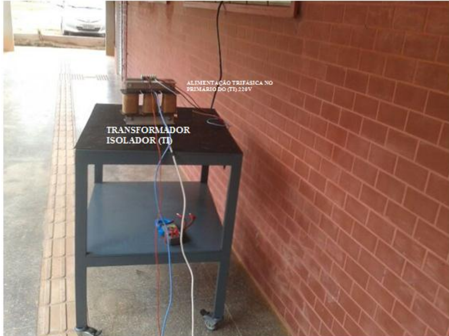
Figura 5.39 – Transformador isolador trifásico 220/380 D/Y – 1kVA
