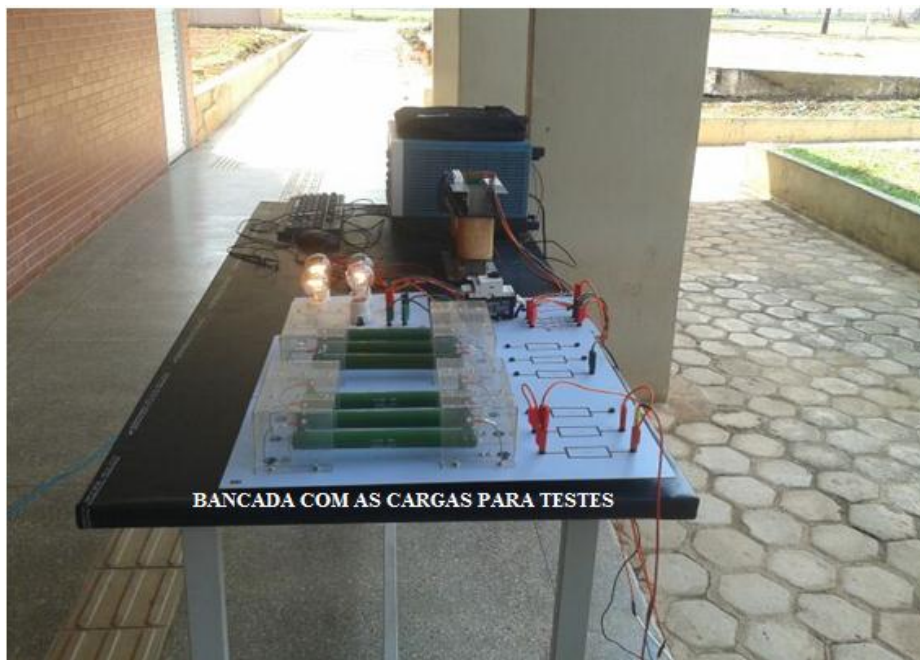
Figura 5.43 – Bancada onde foram realizados os testes com diversas cargas
