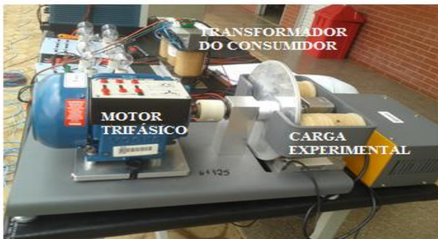
Figura 5.49 – Transformador do consumidor alimentando o motor trifásico com cargas experimentais
