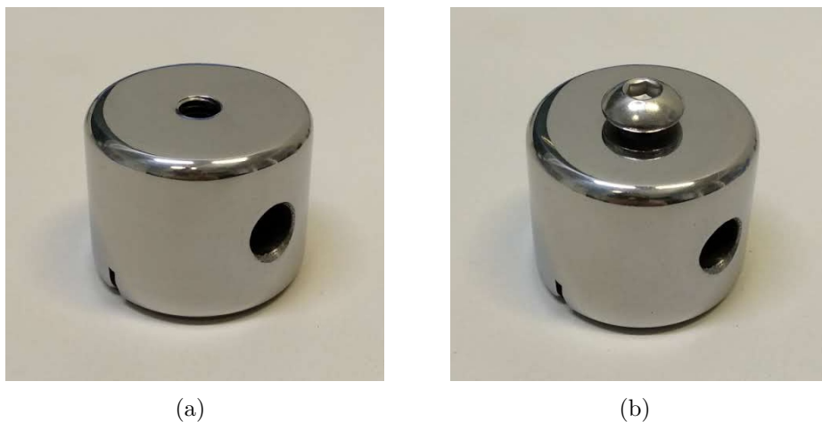
Figura 2.5 – Eletrodo fabricado: (a) Sem parafuso. (b) Com parafuso.
