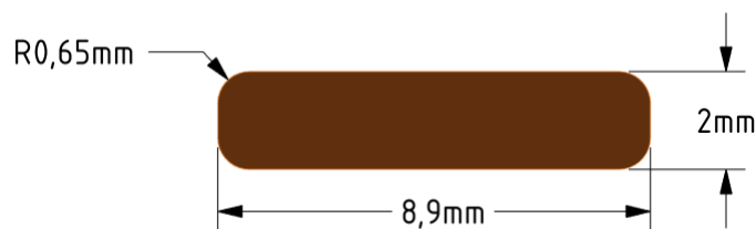
Figura 2.11 – Dimensões do condutor de cobre.
