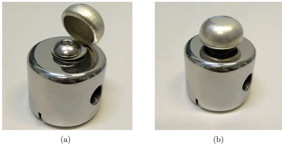
Figura 2.6 – Blindagem anticorona: (a) Aberta. (b) Fechada.
