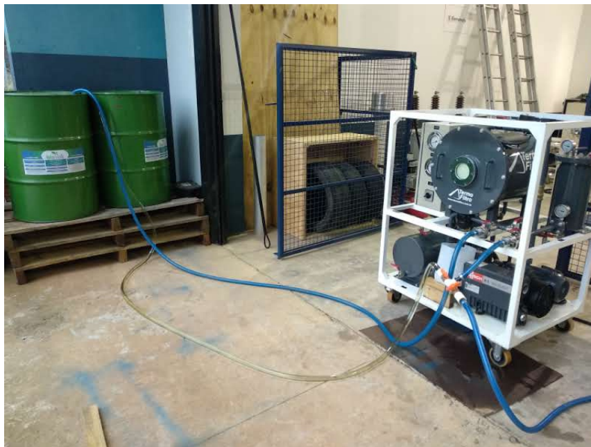
Figura 4.8 – Etapa 1: Tratamento do óleo na termo vácuo.
