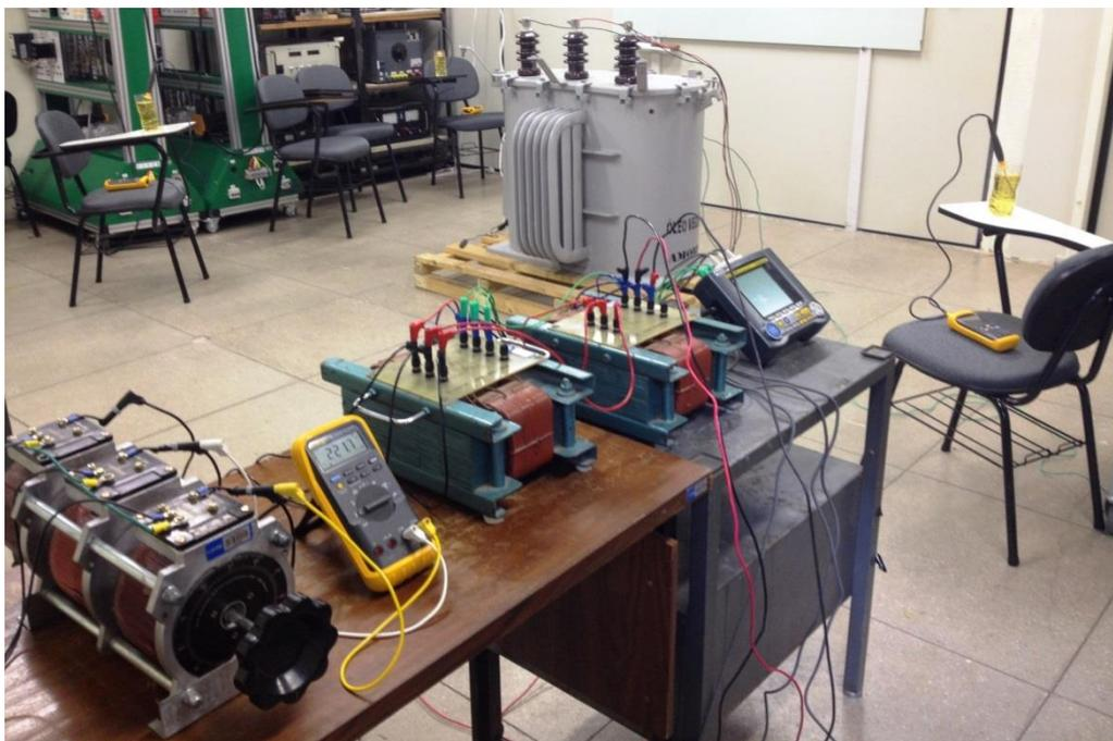
Figura 5.2 – Setup para realização do ensaio de elevação de temperatura.
