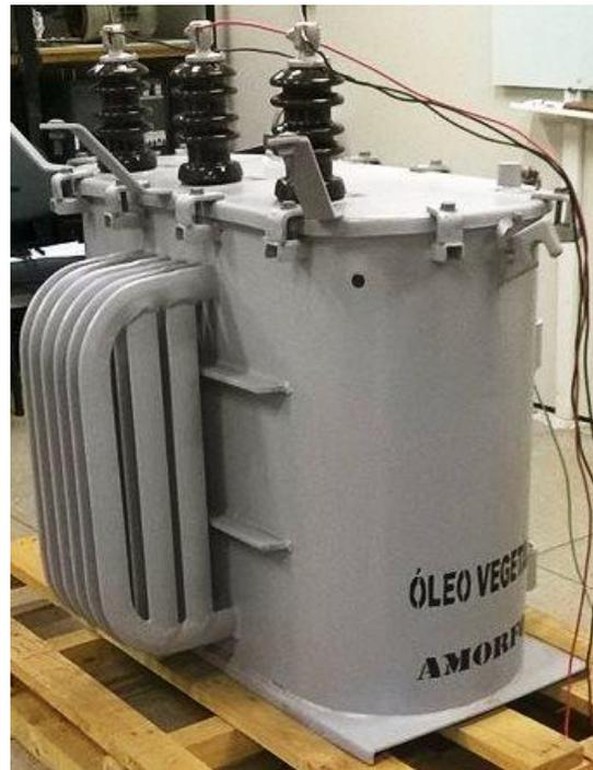
Figura 5.1 – Transformador submetido ao ensaio de elevação de temperatura.
