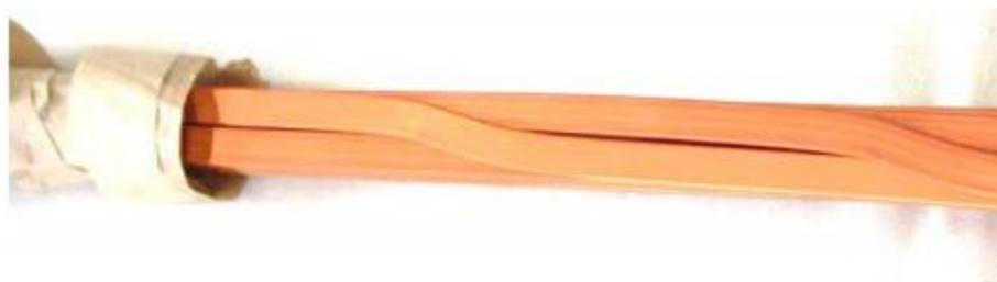
Figura A.12 – Transposição de condutores em paralelo (IARONKA, 2014).
