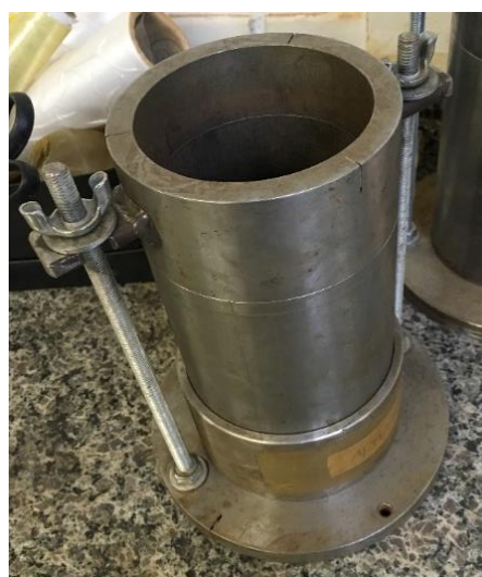
Figura 19 - Cilindro metálico tripartido 100x200 mm utilizado na compactação
