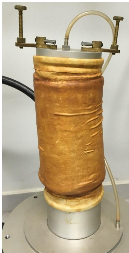
Figura 42 - Corpo de prova do solo PE com deformação excessiva
