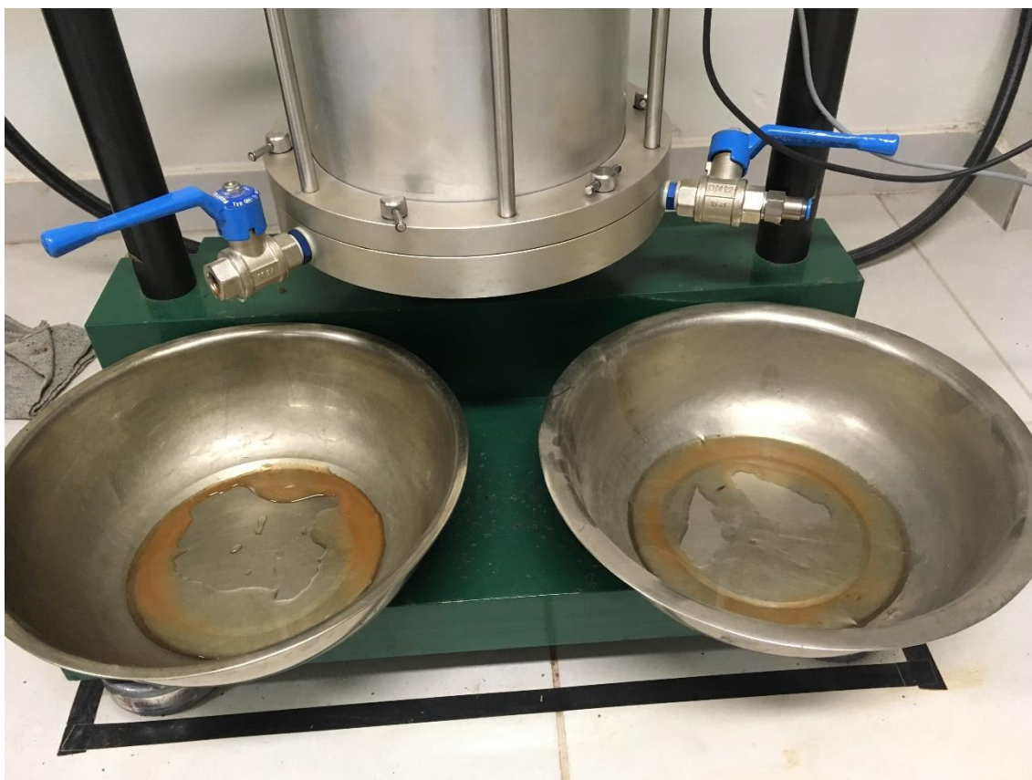
Figura 27 - Exsudação observada durante o ensaio do corpo de prova do solo CA
