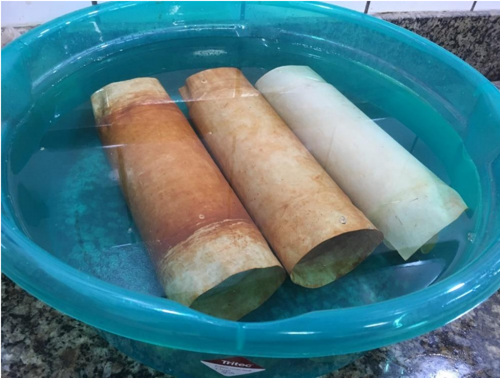
Figura 21 - Corpos de prova do solo CA submersos em água
