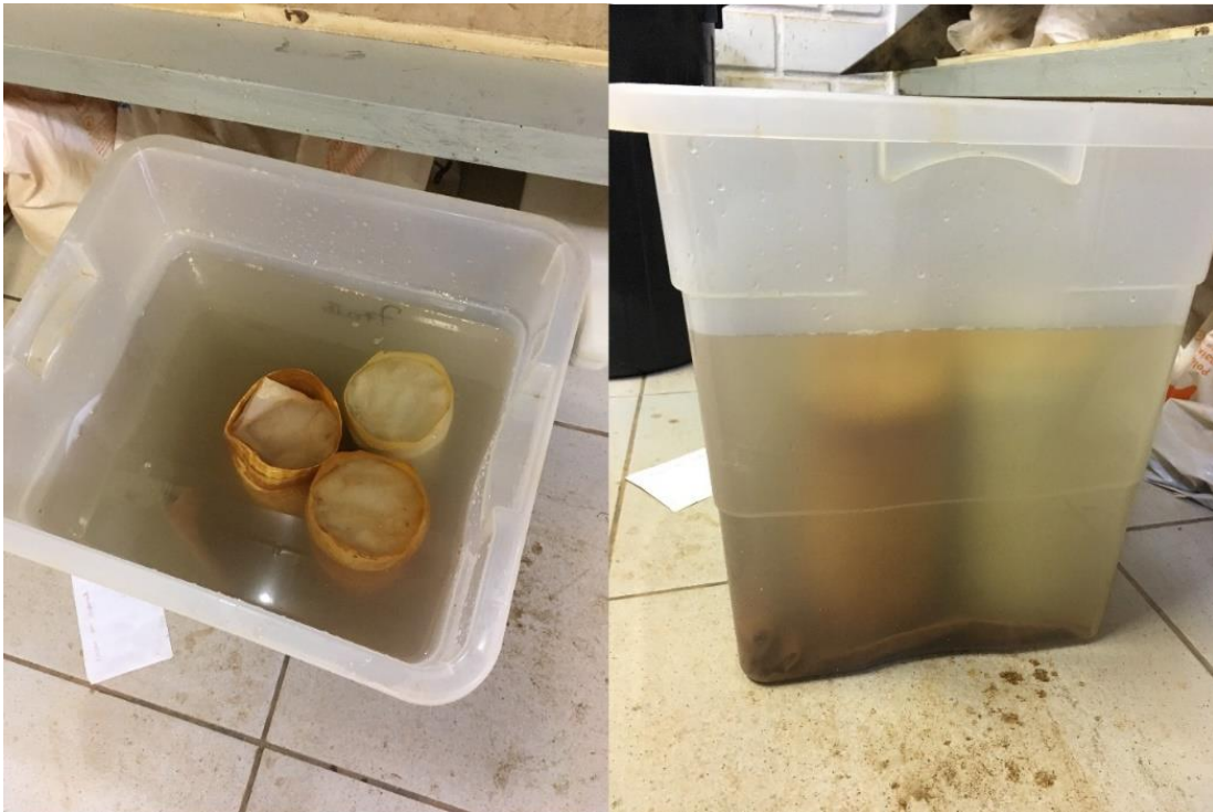
Figura 22 - Corpos de prova do solo PE submersos em água
