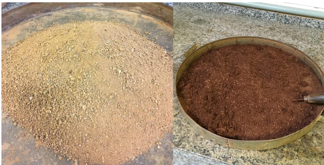
Figura 17 - Processo de homogeneização do solo PE
