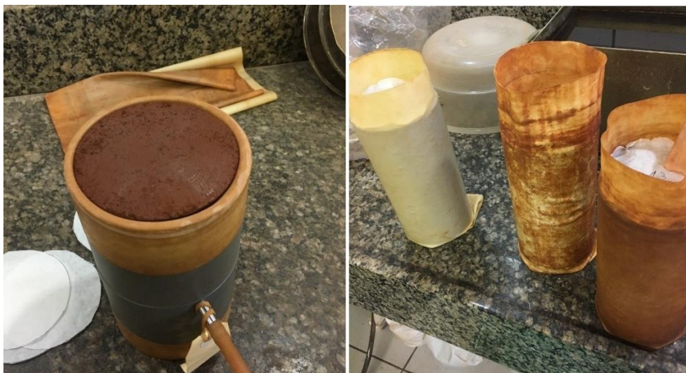
Figura 20 - Corpos de prova sendo encamisados
