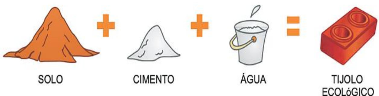
Figura 7 – Representação da composição do tijolo de solo-cimento.
